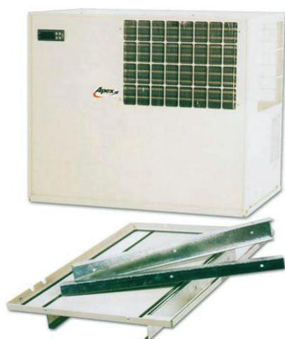
Notre gamme de climatiseurs d'armoires en montage toiture vous propose de série un cadre de fixation unique. Il renforce votre toit d'armoire. Il évite le phénomène dit de « cuvette » qui à l'usage, provoque des infiltrations des condensations d'huiles. De plus un joint polyuréthane collé à chaud sur les deux faces de ce cadre augmente encore la garantie d'étanchéité de votre armoire.
