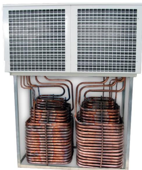
La gamme de refroidisseurs RLC est en détente directe sur le liquide grâce à un échangeur en cuivre ou en inox de type serpentin, à introduire dans le bac du liquide à refroidir (le liquide doit être en mouvement).
